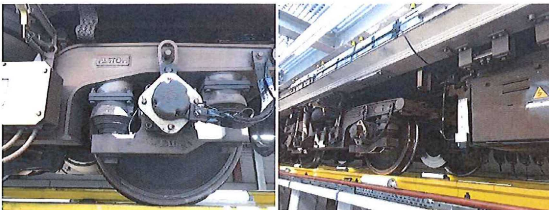
Figuur 2 Links: Trillingsopnemer op draaistel. Rechts: Snelheidsmeter
